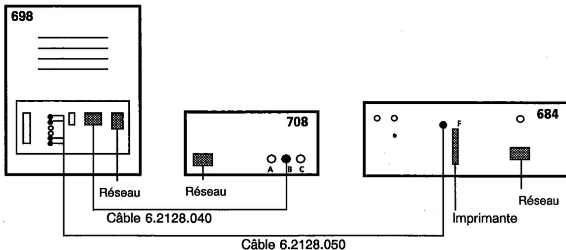
Configurez l'interface RS232 3.540.2441 du Coulomètre KF 684 de sorte que les calculs puissent être effectués sans activer la pesée: Commutateur DIP 8 sur l'interface sur "on".
