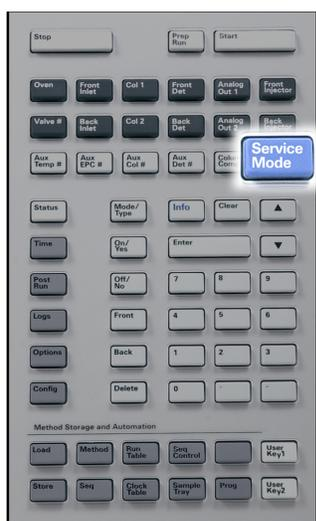
**[Service Mode]** Cette touche permet d'accéder aux réglages et aux fonctions de maintenance, aux compteurs d'entretien et aux diagnostics du CPG. Reportez-vous au [Guide pour utilisateurs avancés](#) pour plus de détails.
