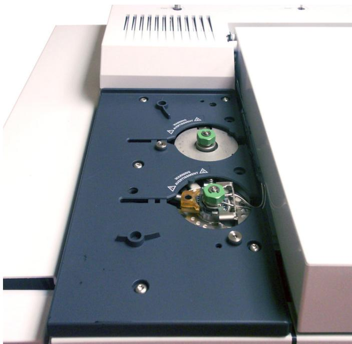
Les échantillons peuvent être injectés dans les injecteurs à la main à l'aide d'une seringue ou à l'aide d'un dispositif d'échantillonnage automatique (comme l'échantillonneur automatique de liquide Agilent ou l'échantillonneur d'espace de tête Agilent).
