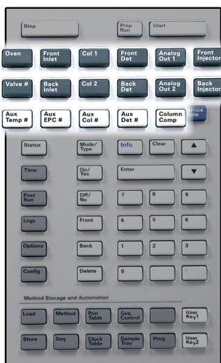
Ces touches permettent de régler la température, la pression, le flux, la vitesse, ainsi que d'autres paramètres opérationnels de méthode.
