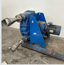
Pompe péristaltique 7,4 m 3 /h PCM DELASCO type DL45 Peristaltic pump
