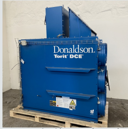
Caisson de dépoussiérage à 6 cartouches DONALDSON TORIT DCE type DFE 3-6-V Dust collector
