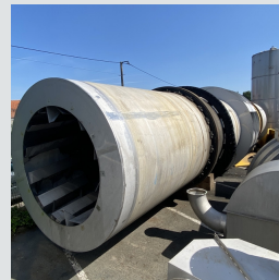
Sècheur refroidisseur tournant COMESSA inox S/S combined rotary tube dryer/cooler
