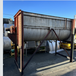
Mélangeur à rubans 3600 litres 30 KW Ribbon mixer
