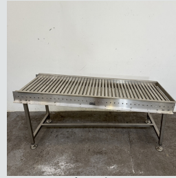
Convoyeur à rouleaux inox longueur 2m S/S roll conveyor
