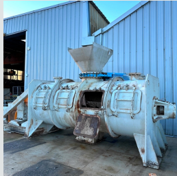
Mélangeur à socs 8000L GRELBEX type MS8000 Steel ploughshare mixer
