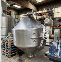
Mélangeur sècheur rotatif 2500 litres ORTH Vacuum rotary bicone dryer
