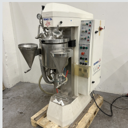
Mélangeur homogénéiseur 15 litres VMI RAYNERI type TXR15L Vacuum homogenizer
