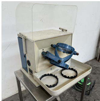
Mélangeur WAB TURBULA T2C Shaker mixer
