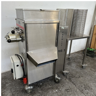
Granulateur FREWITT inox type MG205 S/S oscillating rotor granulator
