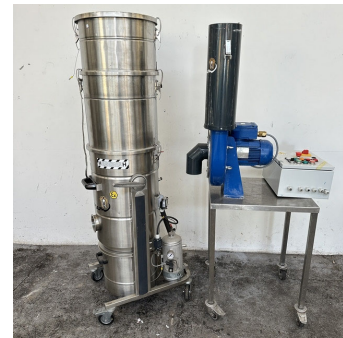
4 séparateurs filtrants inox PHARAON S/S separators
